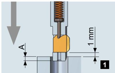
Bei der ganzen Bearbeitung ist weder eine Drehrichtungsänderung noch ein Stillstand der Spindel notwendig. Die Werkzeugschneide wird im Eilvorschub bis vor die obere Bohrungskante, respektive die mögliche Gratkante positioniert.
