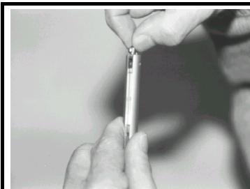
2. Centrare l'inserto passando attraverso il foro con la parte più lunga del perno di montaggio (dalla parte destra dell'utensile come indicato dalla raffigurazione).
