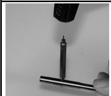
1. Insérez la partie courte de la barette d'assemblage dans le trou transversal de l'autre côté
