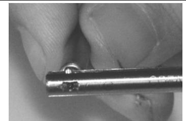
3. Inserire il perno di fissaggio dalla parte opposta (inserire il perno dalla parte senza intaglio). Premere manualmente spingendo così il perno di montaggio verso l'esterno. Il perno rimane circa 1-2mm verso l'esterno.
