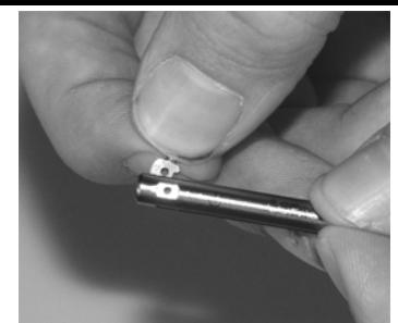
2. Inserire il perno di montaggio con la parte più lunga nel foro centrando così l'inserto.
