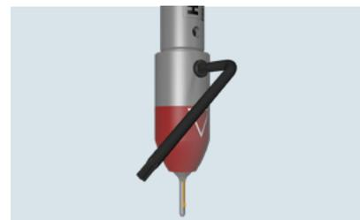
Um den Messerwechsel abzuschliessen, die Klemmschraube mit Hilfe des Torxschlüssels anziehen.
