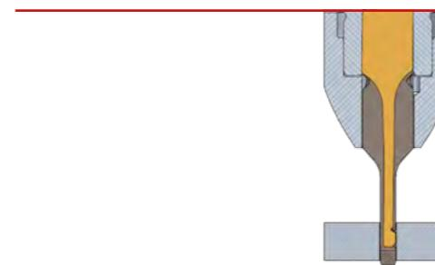
Beim Bohrungsaustritt bringt sich das gefederte Messer selbstständig wieder in die Ausgangsposition zurück.
