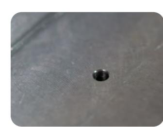
Der definierte Schneidprozess mit einem beschichteten Hartmetallmesser sorgt für einen vollständigen Kantenbruch – die Kante ist grätfrei.
