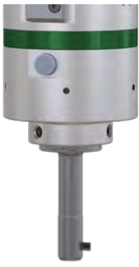
SOLO2 – Messer ist im Stillstand (Spindelstopp) ausgefahren. Eingesetzt wird dieses Werkzeug bis zu einer maximalen Bearbeitungsdrehzahl von 1500 U/min. Die Einfahrdrehzahl des Messers ins Messergehäuse liegt bei 1900 U/min.
