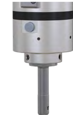
SOLO – das Messer ist im Stillstand (Spindelstopp) eingefahren. Es arbeitet mit einer Mindestdrehzahl von 1900 U/min. Erst nach dem Überschreiten der Mindestdrehzahl fährt das Messer in die Arbeitsposition aus. Das Einfahren des Messers erfolgt über Stoppen der Spindel.
