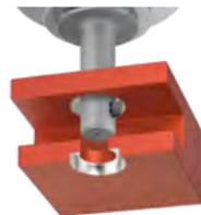
SOLO ermöglicht automatisches Plan- und Formsinken an der Bohrungsvorder- sowie Rückseite ohne Wenden des Werkstücks.
