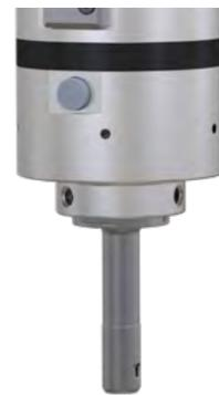
**SOLO – das Messer ist im Stillstand (Spindelstopp) eingefahren.** Es arbeitet mit einer Mindestdrehzahl von 1900 U/min. Erst nach dem Überschreiten der Mindestdrehzahl fährt das Messer in die Arbeitsposition aus. Das Einfahren des Messers erfolgt über Stoppen der Spindel.
