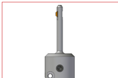
Nástroj s namontovaným nožem SNAP2
