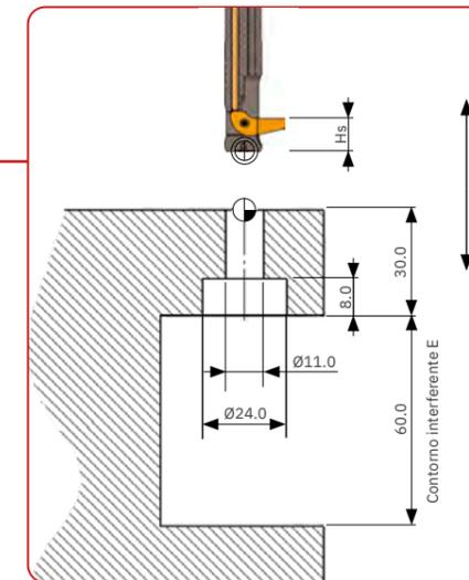
**Agujero de avellanado M10 para tornillo de cabeza cilíndrica con hexágono interior según DIN 974-1**
