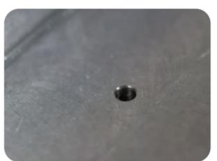
El proceso de corte definido con una cuchilla de metal duro recubierta garantiza un matado de canto, libre de rebaba.
