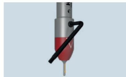
Para completar el cambio de cuchilla, apriete el tornillo de amarre usando la llave Torx.
