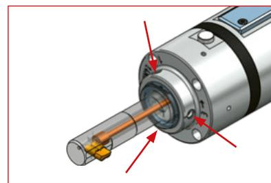
Atornille los 3 tornillos ligeramente. Para ello, observe el valor de par y el orden de atornillado indicados en la carcasa de la unidad de control.
