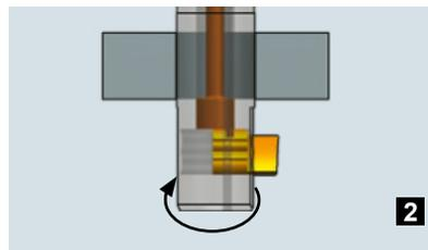
Active el giro del cabezal a derechas. Elija la velocidad de activación correcta para que salga la placa. Atención: Tiempo de espera 1 seg. mínimo. Incremente la velocidad a velocidad de trabajo. Active la refrigeración.
