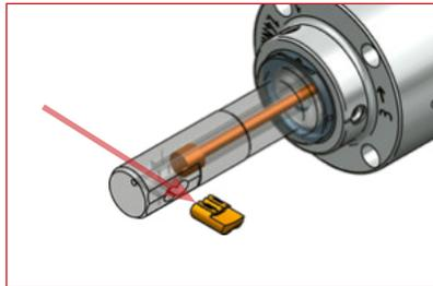
Empuje la placa hacia fuera. Mantenga los dos botones presionados, hasta que la cuchilla esté completamente fuera de la carcasa.
