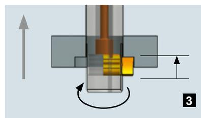
Active el cabezal a derechas con velocidad de activación (velocidad = 1900rev./min.mínimo). La cuchilla se esconde. Pase la pieza con el cabezal girando y en avance alto.
