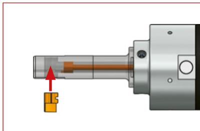
Introduzca la cuchilla en el hueco hasta que el filo de la cuchilla está totalmente visible. Para ello mantenga los dos botones de la unidad de control presionados
