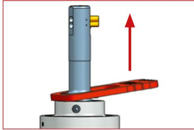
Tire de la carcasa de la cuchilla hacia delante -separándolo de la unidad de control. Siempre debería utilizarse la llave SOLO para la carcasa, pues simplifica el desmontaje.
