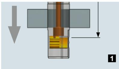
Después de que el cabezal se pare (Revoluciones= 0, la cuchilla escondida), atraviese la pieza en avance alto.
