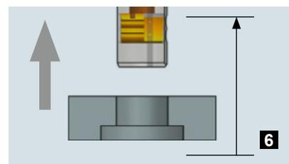
Con el cabezal parado (velocidad = 0) y en avance alto se retira la herramienta de la pieza.
