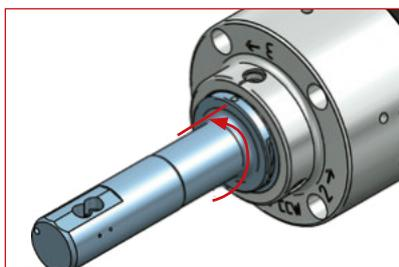
Después, alinee la marca o señal de la carcasa de cuchilla y la unidad de control.
