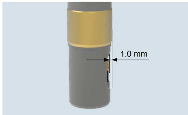
Imagen 2: En este caso la distancia entre la cuchilla y la pared del agujero es suficiente.
