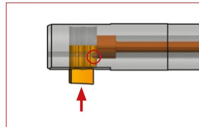
Coloque la cuchilla en la ventana de la carcasa y muévala hasta que la leva encaje en la placa. Se oye claramente un CLICK.
