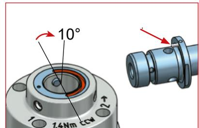
Monte la carcasa de la cuchilla en la unidad de control. Compruebe que la leva de la palanca de control está montada, con un giro de 10° en la ranura de la cuchilla de metal duro.
