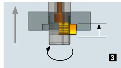
Mecanice la pieza en retroceso en velocidad de trabajo.
