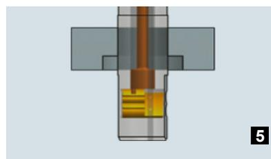
Pare el cabezal, a velocidad de cabezal = 0 para esconder la cuchilla.
