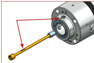
Montaje: Presione la palanca de control (bloqueo a presión + sellado) bien colocada ejerciendo una pequeña fuerza sobre la unidad de control. **Atención:** Compruebe que la marca o señal en la palanca de control y la marca en la unidad de control estén alineadas.
