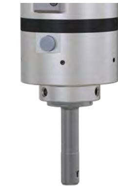
SOLO – Le couteau est rétracté à l'arrêt (arrêt de la broche). Il fonctionne à une vitesse minimale de 1900 tr/min. Ce n'est qu'après avoir dépassé la vitesse de rotation minimale que le couteau sort en position de travail. La rétraction du couteau se fait par arrêt de la broche.
