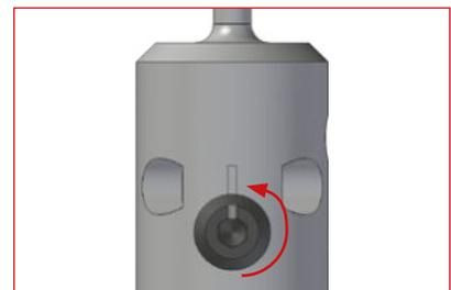
Tourner l'excentrique de 180° jusqu'à ce que les deux repères, excentrique et corps d'outil, soient parfaitement alignés.
