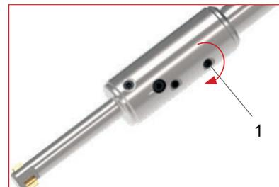
Continuare a ruotare la vite “tensione lame” (1) in senso orario finchè non si ottiene la resistenza desiderata. Il diametro dello smusso precedentemente regolato rimane il medesimo dopo la sostituzione delle lame. Per i valori di riferimento della resistenza delle lame, vedere a pag. 154.
