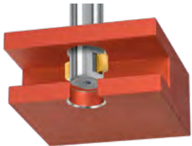
Smussatura in tirata e spinta su tagli interrotti asimmetricamente in un'unica operazione.
