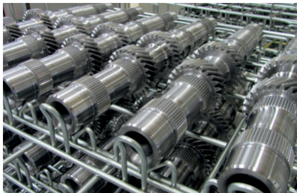
Figura 1: Processo adatto a grandi volumi produttivi. Ad esempio un albero di trasmissione per cambio manuale lavorato su un transfer con SNAP-X
