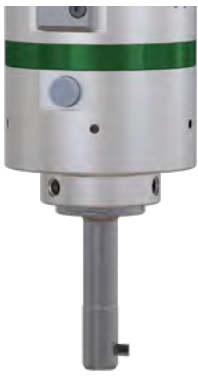
SOLO2 – La lama è estesa in posizione di arresto (arresto del mandrino). Questo utensile è progettato per una velocità di lavorazione massima di 1500 giri/min. La velocità di ritrazione della lama nell’alloggiamento lama è di 1900 giri/min.
