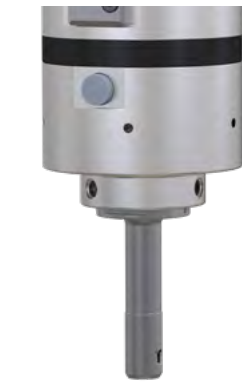
SOLO – La lama è retratta in posizione di arresto (arresto mandrino). Funziona a una velocità minima di 1900 giri/min. La lama si estende in posizione di lavoro solo dopo aver superato la velocità minima. Quando si ferma il mandrino, la lama si ritrae.
