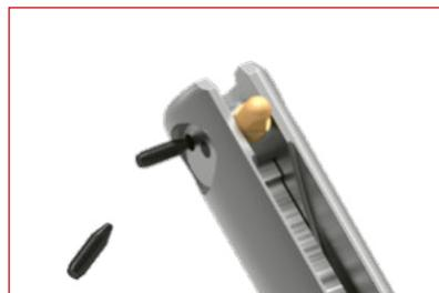
Allentare la vite di serraggio e prendere l'utensile in mano. Rompere manualmente la sezione in eccesso della spina di movimento nel punto di rottura.
