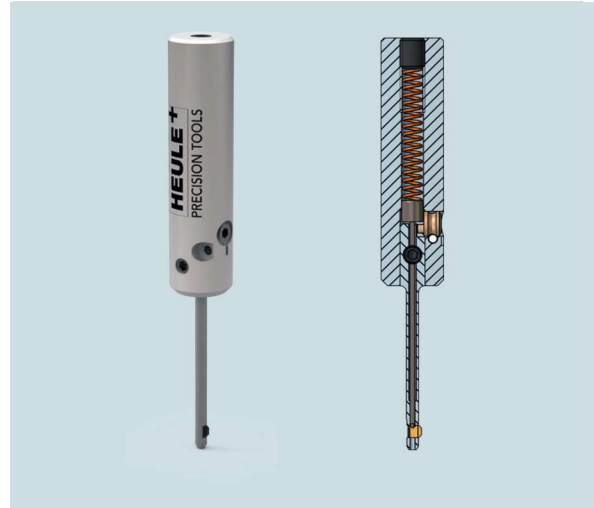
이미지: SNAP2- 치수상의 문제로 공구는 공구 몸체와 블레이드 하우징 2 개의 부품으로 이루어져 있습니다.
