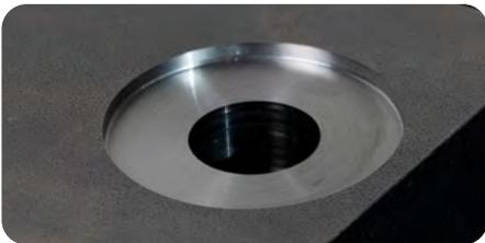
Die sauberen Plansenkungen bis 2.3xØd in anspruchsvollen Werkstoffen sowie die überdurchschnittlich hohen Standzeiten der Hartmetallmesser überzeugen.
