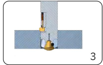
Bei der ganzen Bearbeitung ist weder eine Drehrichtungsänderung noch ein Stillstand der Spindel notwendig. Das Bohr-Werkzeug wird im Eilvorschub vor dem Werkstück positioniert.
