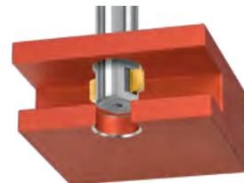
Fasen von asymmetrisch unterbrochenen Bohrungskanten – vor- und rückwärts in einem Arbeitsgang.
