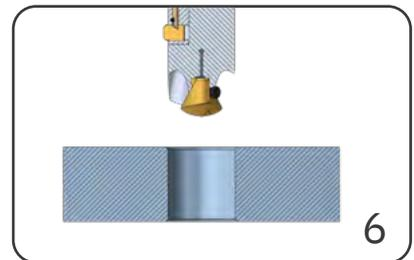
Bohrbearbeitung abschliessen und im Eilvorgang in die Ausgangsposition für die Rückwärtsbearbeitung (Grathöhe + 1mm) fahren.
