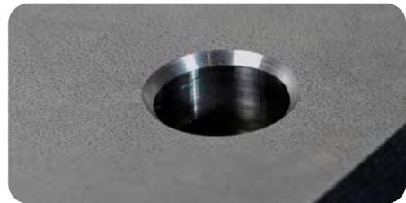
Unabhängig von der Höhe der zu bearbeitenden Fläche erzeugt SNAP immer eine gleichbleibende Fase.
