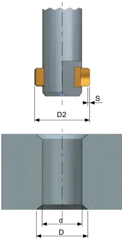
Der gewünschte Fasdurchmesser **D** wird über den Einstelldurchmesser **D2** eingestellt. Der maximale D2 darf nicht überschritten werden (siehe Werkzeugtabellen Seiten 112 ff.)
