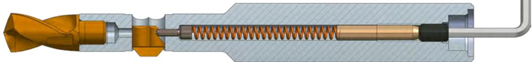
Die Messerkraft beim VEX-S kann mit Hilfe des Gewindestifts auf die Anwendung angepasst werden. Die Messerkraft soll so stark eingestellt werden, dass nach dem Austritt des Messers aus der Bohrung das Messer vollständig ausfährt. Damit ist sichergestellt, dass das Messer auch die nötige Schneidleistung aufbringen kann. Je zäher der Werkstoff, desto härter soll die Feder eingestellt werden.
