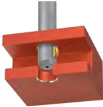
Ohne das Werkstück zu wenden oder die Spindel zu stoppen, befreit SNAP auch schwer zugängliche Bohrungskanten vom Grat und versieht sie zuverlässig mit einer Fase.
