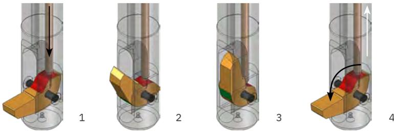
1 Die Innenkühlung (IK), die Luftzufuhr oder die manuelle Betätigung bauen Druck auf den Kolben auf. Das Messer wird über den Steuerbolzen, der auf die Druckfläche (rot) einwirkt, zum Einklappen gebracht.
