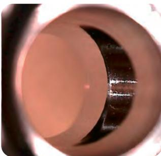
Der definierte Schneidprozess sorgt für einen vollständigen Kantenbruch. Die Kante ist gratfrei.
