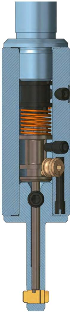
Das DEFA Faswerkzeug zeichnet sich durch zwei Messer mit einer speziellen Schneidengeometrie aus. Die beiden Fasmesser werden von einer unter Federdruck stehenden Steuerwippe im Werkzeuggrundkörper gehalten.
