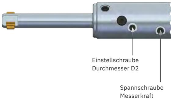
Die Kraft, die radial auf die Messer wirkt, sollte mindestens so gross sein, dass die Messer unter Arbeitsbedingungen (Schmutz, Kühlwasser etc.) zuverlässig auf den eingestellten D2 ausfahren.
