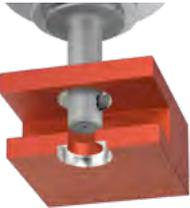
SOLO ermöglicht automatisches Plan- und Formsensen an der Bohrungsvorder- sowie Rückseite ohne Wenden des Werkstücks.
