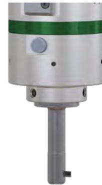
**SOLO2 – Messer ist im Stillstand (Spindelstopp) ausgefahren.** Eingesetzt wird dieses Werkzeug bis zu einer maximalen Bearbeitungsdrehzahl von 1500 U/min. Die Einfahrdrehzahl des Messers ins Messergehäuse liegt bei 1900 U/min.
