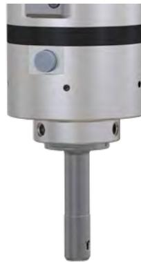
**SOLO – das Messer ist im Stillstand (Spindelstopp) eingefahren.** Es arbeitet mit einer Minstdrehzahl von 1900 U/min. Erst nach dem Überschreiten der Minstdrehzahl fährt das Messer in die Arbeitsposition aus. Das Einfahren des Messers erfolgt über Stoppen der Spindel.
