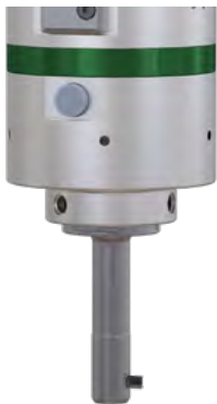
SOLO2 – Le couteau est déployé à l'arrêt (arrêt de la broche). Cet outil est utilisé jusqu'à une vitesse d'usinage maximale de 1500 tr/min. La vitesse de rétraction du couteau dans le porte-couteau est de 1900 tr/min.
