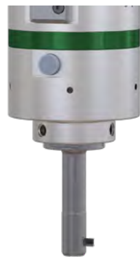
SOLO2 - 정지 상태(스핀들 스톱) 에서 블레이드가 확장됩니다. 이 공구는 최대 1500 U/min의 가공 속도까지 사용됩니다. 블레이드가 블레이드 하우징에 들어가는 속도는 1900 U/min입니다.
