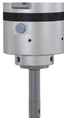
SOLO - 정지 상태(스핀들 스톱) 에서는 블레이드가 접혀 있습니다. 이는 최소 1900 U/min의 속도로 작동합니다. 최저 속도를 초과하면 블레이드가 작업 위치까지 확장됩니다. 스핀들을 정지하면 블레이드가 접힙니다.
