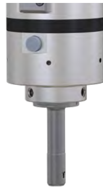
SOLO - 정지 상태(스핀들 스톱) 에서는 블레이드가 접혀 있습니다. 이는 최소 1900 U/min의 속도로 작동합니다. 최저 속도를 초과하면 블레이드가 작업 위치까지 확장됩니다. 스톱을 정지하면 블레이드가 접힙니다.
