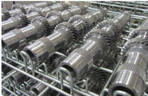
Obrázek 1: spolehlivost ve velkosériové výrobě – příklad odhrotování hnacích hřídelů pro ruční převodovku pomocí SNAP-X na transferové lince
