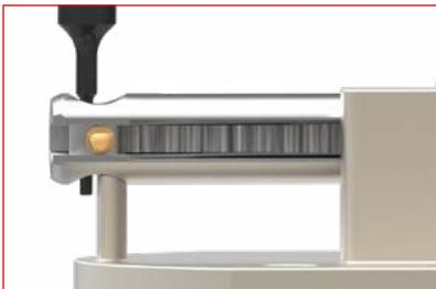
Mit Montagestift durch Spreizstift-Öffnung fahren, um die richtige Messerposition zu bestimmen und für den neuen Spreizstift vor zu zentrieren.
