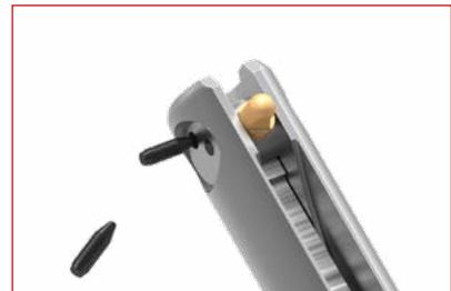
Klemmschraube lösen und Werkzeug herausnehmen. Zum Schluss das auf der anderen Seite herausragende Stück des Spreizstifts an der Sollbruch-Stelle von Hand abbrechen.
