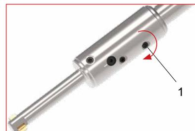
Spannschraube (1) soweit nach rechts drehen bis gewünschte Messerkraft erreicht ist. Die zuvor eingestellte Fasengrösse wird durch den Messerwechsel nicht verändert. Einstellwerte für die Messerkraft siehe Seite 154.
