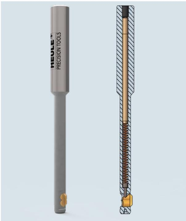
*Bild: SNAP5 - Die B-Form des Messers, welche fertigungsbedingt aufwändiger ist, hat sich aufgrund ihrer besserer Führungseigenschaften bei diesem Werkzeugtyp bewährt.*
