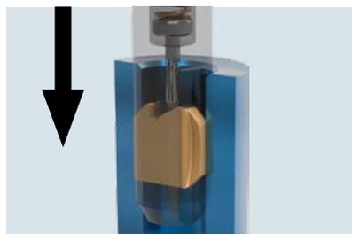
Auf einer speziell ausgebildeten Gleitpartie gleitet das Messer durch die Bohrung, ohne sie zu verletzen. Auch geriebene Bohrungen können **ohne** Beschädigung durchfahren werden.
