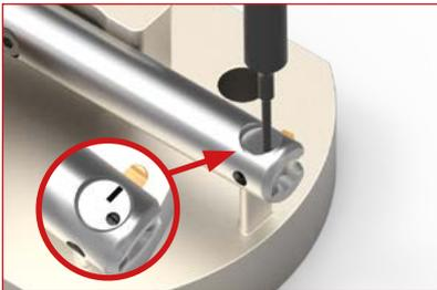
Auf dem Messerhalter sind der Markierungsstrich und der schwarz brünierte Spreizstift sichtbar (siehe auch Hinweis S. 57). Spreizstift mit dem Montagestift (kleinerer Durchmesser) durch den Messerhalter durchschlagen (nur eine De-/Montagerichtung!).
