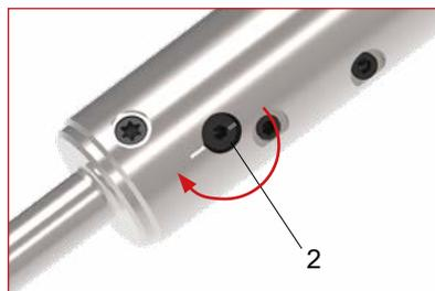
Exzenter (2) wieder zurück drehen bis **leichter** Widerstand spürbar wird. Markierungen stehen anschliessend zueinander.
