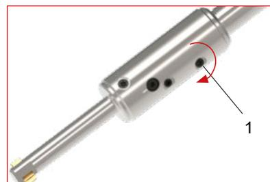
Continuez à tourner la vis de tension (1) dans le sens horaire jusqu'à ce que la pression recherchée des couteaux soit atteinte. Le pré-réglage du diamètre du chanfrein reste le même avant et après le changement de couteaux. Pour la force des couteaux veuillez vous reporter à la page 154.
