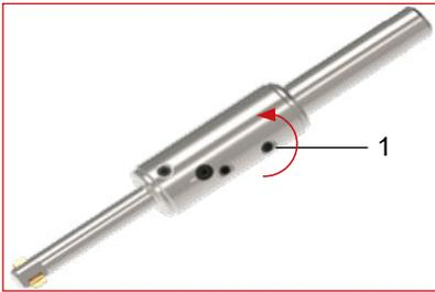
Tournez la vis de tension dans le sens anti-horaire jusqu'à ce que les couteaux se laissent presser facilement à la main. Ne changer les couteaux que lorsque ceux-ci ne sont «mou», c'est-à-dire sans être sous pression.
