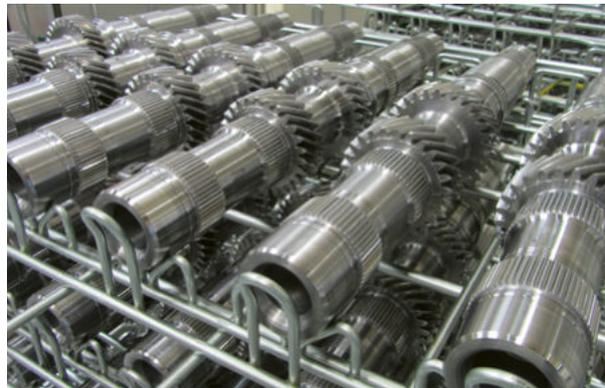
Fig. 1: Système SNAP-X compatible pour des séries de pièces importantes. Exemple: arbres d'entraînement de boîtes de vitesses manuelles usinées sur des machines transferts.
