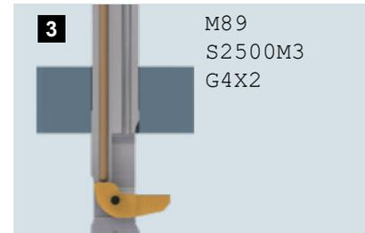
Arrêter l'arrosage machine, démarrer la broche machine<sup>2</sup>, prévoir une temporisation de 1 à 2 secondes (attention: arrêt total de l'arrosage), le couteau pivote dans sa position d'usage.
