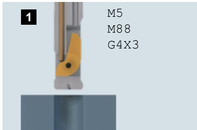
Position de l'outil au dessus de la pièce, broche arrêtée, fonction arrosage en marche avec une temporisation de 2 à 5 secondes (suivant la pompe d'arrosage). La lame se rétracte.
