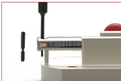
Insérer la nouvelle goupille sur une faible longueur dans le trou, jusqu'à ce que l'arrière de celle-ci soit alignée par rapport au corps de l'outil.
