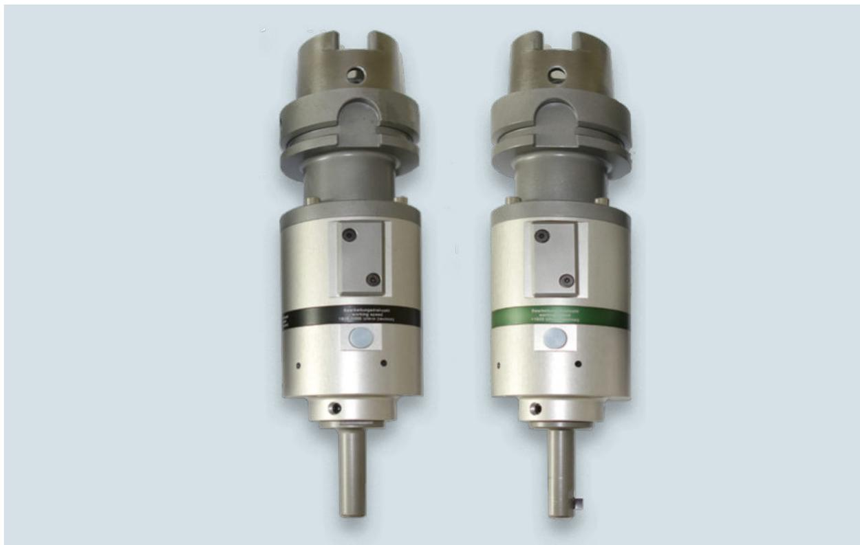
Fig. 1: A gauche le SOLO, à droite le SOLO2. Tous deux avec des queues d'outils HSK.
