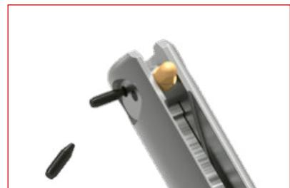
Retirer l'outil de son système de montage et le prendre dans vos mains. Enlever manuellement la partie de la goupille dépassant le corps d'outil.
