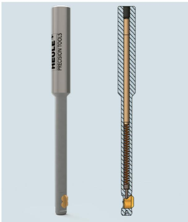
Fig. 2: La forme en « B » du couteau est plus difficile à réaliser en fabrication. Cependant, ses capacités de guidage améliorées justifient cette conception pour cette taille d'outil.
