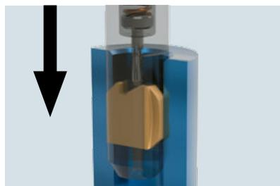
Malgré la rotation de la broche, le couteau passe à travers l'alésage sans l'endommager. Même un trou alésé peut être parcouru sans aucun dommage.
