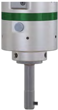
SOLO2 – Le couteau est déployé à l'arrêt (arrêt de la broche). Cet outil est utilisé jusqu'à une vitesse d'usinage maximale de 1500 tr/min. La vitesse de rétraction du couteau dans le porte-couteau est de 1900 tr/min.
