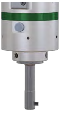
SOLO2: la cuchilla se extiende cuando el husillo está parado. La herramienta trabaja hasta una velocidad máxima de 1500 rpm. La cuchilla se retrae en la carcasa de la herramienta a una velocidad de 1900rpm.
