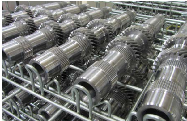
Bild 1: Prozesssicher in der Grossserienfertigung - Als Beispiel Antriebswellen für ein manuelles Getriebe entgrated mit SNAP-X auf einer Transferstrasse.
